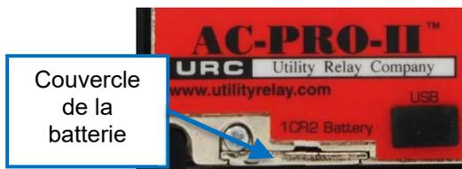
Figure 21.1: Couvercle de la batterie
